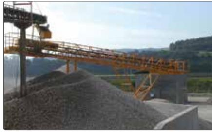
**Каркасный мост с ленточным конвейером для гравия**
