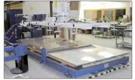
**Подающая каретка для лазерной резки**
